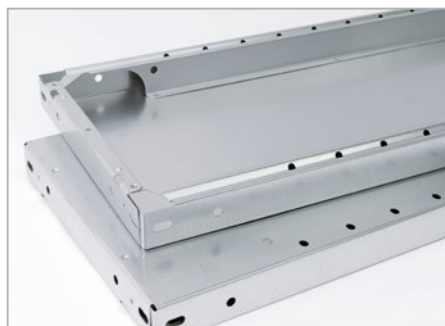
Stahlfachboden mit Abkantung für höchste Stabilität und für optimale Benutzersicherheit sowie Systemlochung im Raster 25 mm für steckbares Zubehör
